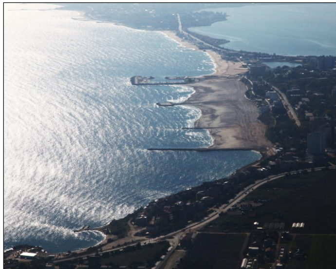
Fig. 3.12. Eforie North - actual protection scheme - 2016
